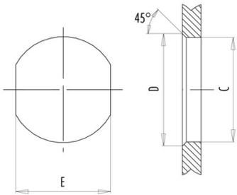
Mit Gewinde, einschraubbar/With thread to screw in
